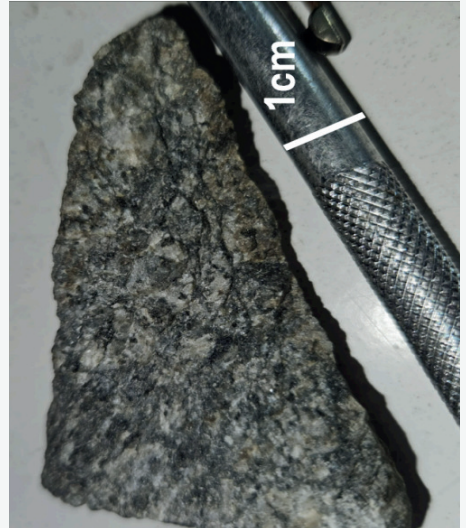
Brecha de falla que atraviesa una roca tonalita
